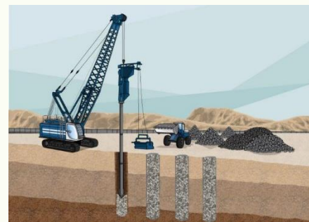
Gambar 13. Stone Column Menggunakan Teknik Vibro Replecement
