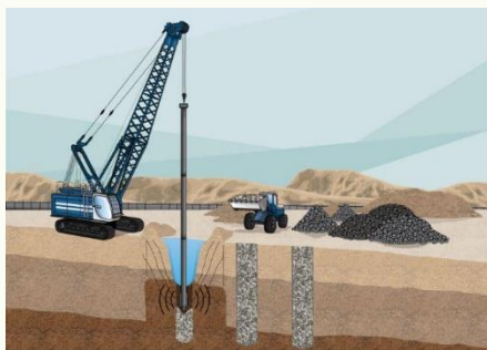
Gambar 12. Stone Column Menggunakan Teknik Vibro Replecement
