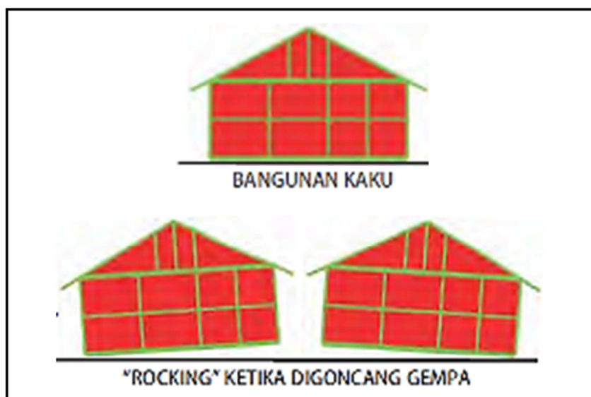
Gambar 4 , Bentuk bangunan ketika menerima goncangan
